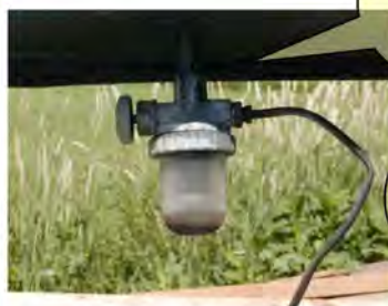
カップに亀裂と配管の折れ
